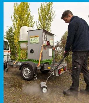
Ce procédé utilise une eau à haute température. L'eau chaude est pulvérisée sur la plante à détruire
