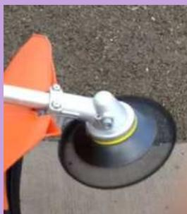
Cette technique fonctionne grâce à une brosse qui se fixe sur la débroussailleuse et permet l'arrachage des plants.
